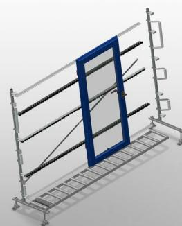
Rulliera verticale per il trasporto e l'immagazzinaggio di elementi di finestra. Solida struttura in acciaio. Espansione in un sistema modulare. Rulliera verticale per il trasporto continuo e l'immagazzinaggio di elementi di finestra. Facilità di manovrare gli elementi di finestra. Ogni unità di rulliera è lunga 4.000 mm. Rulliera suddivisa in 3 parti. Listelli scorrevoli in PVC superiori e inferiori. Tre guide a rotelle con rulli in gomma, diametro 50 mm. Unità di base senza montante terminale.
