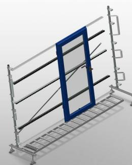
Rulliera verticale per il trasporto e l'immagazzinaggio di elementi di finestra. Solida struttura in acciaio. Espansione in un sistema modulare. Rulliera verticale per il trasporto continuo e l'immagazzinaggio di elementi di finestra. Facilità di manovrare gli elementi di finestra. Ogni unità di rulliera è lunga 4.000 mm. Rulliera suddivisa in 3 parti. Listelli scorrevoli in PVC superiori e inferiori. Tre guide a rotelle con rulli in gomma, diametro 50 mm. Unità di base senza montante terminale.
