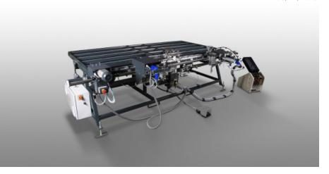
用于塑料和铝合金窗扇五金件安装的窗扇组装台。在最短时间内以符合人体工程学的方式上紧五金件。五金配件组装台用于对五金件进行测量和裁切。通过多种工序来优化窗框加工。组装工作台可气动倾斜。窗扇测量和定心装置可以气动方式移动。带有用于中间锁点和固定锁点止动器的五金件冲压机。两个用于不同窗扇宽度的止动器。可移动且由气动调节高度的螺钉紧固装置。用于第二种长度的螺丝钉的手动送料斗。自动紧固深度控制。螺钉输送装置。带塑料滑条的工作台支承面。
