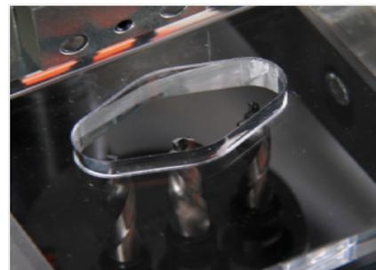
执手孔钻孔装置 (选修的)
