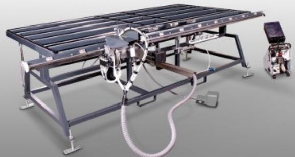
用于塑料窗扇五金件安装的窗扇组装台。在最短时间内以符合人体工程学的方式上紧五金件。五金配件组装台用于对五金件进行测量和裁切。通过多种工序来优化窗框加工。组装工作台可气动倾斜。窗扇测量和定心装置可以气动方式移动。带有用于中间锁点和固定锁点止动器的五金件冲压机。两个用于不同窗扇宽度的止动器。可移动且由气动调节高度的螺钉紧固装置。螺钉输送装置。带塑料滑条的工作台支承面。
