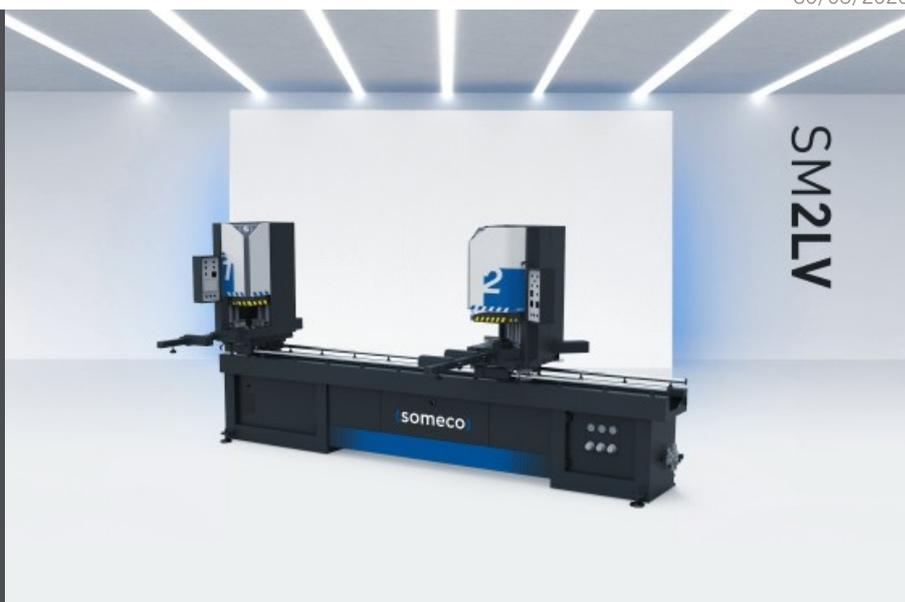
拥有自动循环功能带固定头的在线焊接机、可以实现 90° 以及 30° 至 180° 的可变角度焊接。SM 2LV 最大可用长度为 3.440 mm、提供配备加热切割刀和无加热切割刀两个版本。SM 2LV 配备了焊珠限位器（可以在设置过程中设定在 0.2 至 2 mm 的范围内）、还包括多个可以在直线导轨上滑动的垂直钳口。熔焊深度可以设置为 2.5 或 3 mm、支撑臂高度可调节。SM 2LV 可以配备反凸模具（选配）来完成标准焊接和无缝焊接、并能够加工所有类型的标准、丙烯酸以及涂层型材。这款焊接机可以配置快速更换系统、与 SM 4H 四头焊接机共用反凸模具。此外、还与获得专利的无缝反凸模具相兼容、通过几步简单的型材准备步骤即可在框架表面完成无缝焊接。这种焊接方法大大缩短并简化了后续加工周期、对生产率和成品质量都有重大提升。可以轻松清洁特氟龙涂层薄膜。可以通过 PLC 控制工作周期、通过数字温度控制器控制加热板（可以设置为摄氏度或华氏度）、LCD 显示屏允许设置加热时间。
