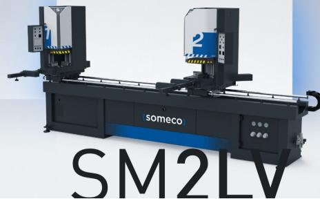
拥有自动循环功能带固定头的在线焊接机、可以实现 90° 以及 30° 至 180° 的可变角度焊接。SM 2LV 最大可用长度为 3.440 mm、提供配备加热切割刀和无加热切割刀两个版本。SM 2LV 配备了焊珠限位器（可以在设置过程中设定在 0.2 至 2 mm 的范围内）、还包括多个可以在直线导轨上滑动的垂直钳口。熔焊深度可以设置为 2.5 或 3 mm、支撑臂高度可调节。SM 2LV 可以配备反凸模（选配）来完成标准焊接和无缝焊接、并能够加工所有类型的标准、丙烯酸以及涂层型材。这款焊接机可以配置快速更换系统、与 SM 4H 四头焊接机共用反凸模。此外、还与获得专利的无缝反凸模相兼容、通过几步简单的型材准备步骤即可在框架表面完成无缝焊接。这种焊接方法大大缩短并简化了后续加工周期、对生产率和成品质量都有重大提升。可以轻松清洁特氟龙涂层薄膜。可以通过 PLC 控制工作周期、通过数字温度控制器控制加热板（可以设置为摄氏度或华氏度）、LCD 显示屏允许设置加热时间。
