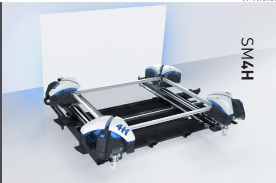
SM 4H 是用于 PVC 型材焊接的数字化控制水平焊接机。焊接机采用两种尺寸制成，可以同步焊接四个 90° 角，生产框架。标准版可以控制焊缝的大小，可以根据后续清洁加工所要求的精细度规格来预定义其厚度。还可以选配专利的电子调节系统，该系统可以在 0.2 mm 至 2 mm 的范围内管理焊缝的尺寸。SM 4H 与可以实现无缝焊接的无缝技术反凸模具相兼容。这种焊接模式显著缩短并简化了后续的加工周期，在生产力和产品质量上具有很大优势。机器可以进行手动装载或自动装载。其设计更好地满足了人体工学和安全性的要求，灯光指示器和焊接头的移动装置使操作员与机器之间的对话更为简单直观，不论是在型材加载阶段还是在后续的加热和焊接阶段。加工周期中的所有变量（焊接时间、速度等）都可以进行编程并在机器中自动设置。
