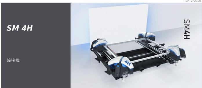
与可以实现无缝焊接的无缝技术反凸模具相兼容。这种焊接模式显著缩短并简化了后续的加工周期,在生产力和产品质量上具有很大优势。 机器可以进行手动装载或自动装载。其设计更好地满足了人体工学和安全性的要求,灯光指示器和焊接头的移动装置使操作员与机器之间的对 话更为简单直观,不论是在型材加载阶段还是在后续的加热和焊接阶段。
