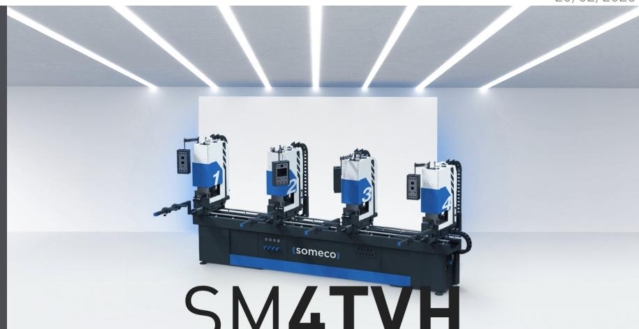
4个头在线焊接机、全自动周期、用于90°角度、从30°到180°可变角度、T型横条、H型横条和十字横条。SM 4TVH 有三个不同长度（3.440, 4.440 和 5.440 mm） 、另外用1个或者多头能够同时给3个框架加热。配有的加热焊缝限制器可以调节在 0,5 到 2 mm 范围内。SM 4TVH 有滑动垂直夹具。焊接深度可以调节在 2,5 或者 3 mm、另外可以调节支撑架的高度。根据需要、SM 4TVH 可以配样板（另外加的） 、以加工所有的标准、亚克里和贴面型材以及大规格的型材（单件） 。配有快速更换装置以便特氟隆薄膜的清洗。运转周期由 PLC 控制的、加热板由数字温度调节器控制（可设置 °C 或 °F） 。通过 LCD 显示器、可以设定加热时间和焊接时间。
