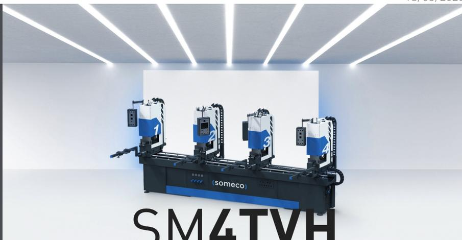
4个头在线焊接机、全自动周期、用于90°角度、从30°到180°可变角度、T型横条、H型横条和十字横条。SM 4TVH 有三个不同长度（3.440, 4.440 和 5.440 mm）、另外用1个或者多头能够同时给3个框架加热。配有的加热焊缝限制器可以调节在 0,5 到 2 mm 范围内。SM 4TVH 有滑动垂直夹具。焊接深度可以调节在 2,5 或者 3 mm、另外可以调节支撑架的高度。根据需要、SM 4TVH 可以配样板（另外加的）、以加工所有的标准、亚克力和贴面型材以及大规格的型材（单件）。配有快速更换装置以便特氟隆薄膜的清洗。运转周期由 PLC 控制的、加热板由数字温度调节器控制（可设置 °C 或 °F）。通过 LCD 显示器、可以设定加热时间和焊接时间。
