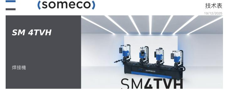
4个头在线焊接机、全自动周期、用于90°角度、从30°到180°可变角度、T型横条、H型横条和十字横条。SM 4TVH 有三个不同长度(3.440, 4.440 和 5.440 mm) 、另外用1个或者多头能够同时给3个框架加热。配有的加热焊缝限制器可以调节在 0,5 到 2 mm 范围内。SM 4TVH 有 滑动垂直夹具。焊接深度可以调节在 2,5 或者 3 mm、 另外可以调节支撑架的高度。根据需要、SM 4TVH 可以配样板(另外加的)、以加工 所有的标准、亚克里和贴面型材以及大规格的型材(单件)。配有快速更换装置以便特氟隆薄膜的清洗。运转周期由 PLC 控制的、加热板由数 字温度调节器控制(可设置 ℃ 或 °F)。通过 LCD 显示器、可以设定加热时间和焊接时间。
