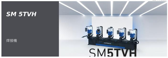
5个头在线焊接机、全自动周期、用于90°角度、从30°到180°可变角度、T型横条、H型横条和十字横条。SM 5TVH 有两个不同长度(4.440 和5.440 mm)、另外用1个或者多头能够同时给4个框架加热。配有的加热焊缝限制器可以调节在 0,5 到 2 mm 范围内。SM 5TVH 有滑动垂直夹具。焊接深度可以调节在 2,5 或者 3 mm、另外可以调节支撑架的高度。根据需要、SM 5TVH 可以配样板(另外加的)、以加工所有的标准、亚克里和贴面型材以及大规格的型材(单件)。配有快速更换装置以便特氟隆薄膜的清洗。运转周期由 PLC 控制的、加热板由数字温度调节器(可设置 °C 或 F)。通过 LCD 显示器、可以设定加热时间和焊接时间。
