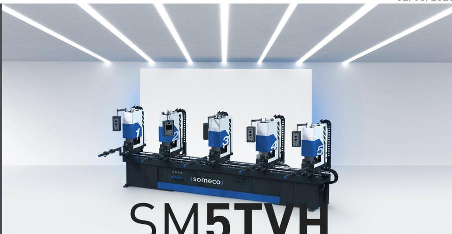
5个头在线焊接机、全自动周期、用于90°角度、从30°到180°可变角度、T型横条、H型横条和十字横条。SM 5TVH 有两个不同长度（4.440 和 5.440 mm）、另外用1个或者多头能够同时给4个框架加热。配有的加热焊缝限制器可以调节在 0,5 到 2 mm 范围内。SM 5TVH 有滑动垂直夹具。焊接深度可以调节在 2,5 或者 3 mm、另外可以调节支撑架的高度。根据需要、SM 5TVH 可以配样板（另外加的）、以加工所有的标准、亚克力和贴面型材以及大规格的型材（单件）。配有快速更换装置以便特氟隆薄膜的清洗。运转周期由 PLC 控制的、加热板由数字温度调节器（可设置 °C 或 F）。通过 LCD 显示器、可以设定加热时间和焊接时间。
