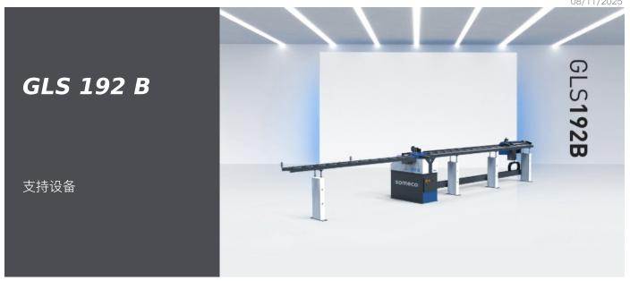
气动切割机用于进行 V 字切割(切割角度: 2x45°)、配有特殊的刀片(呈上下排列)、可以同时切割玻璃压条的后部接缝。这款机床标配一个特殊的气动垂直夹持装置、可以同时加工多个玻璃压条。
