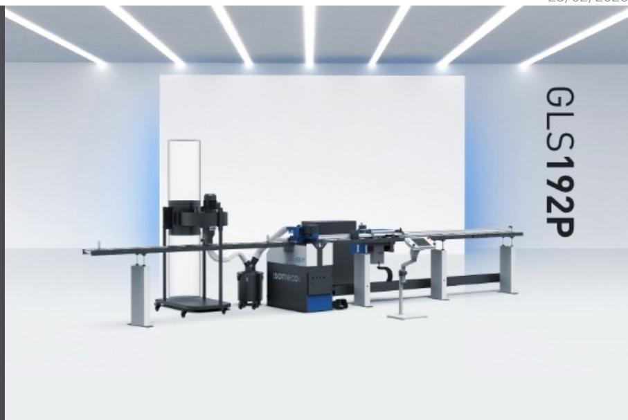
气动切割机用于进行 V 字切割（切割角度：2x45°）、配有特殊的刀片（呈上下排列）、可以同时切割玻璃压条的后部接缝。这款机床标配一个特殊的气动垂直夹持装置、可以同时加工多个玻璃压条。
