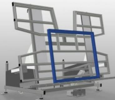
用于垂直和水平安装的组装工作台。钢制结构、坚固稳定。在从垂直输送切换至水平输送或相反时十分重要。时垂直和水平安装的理想之选。通过可无级调节的无级中间位置实现符合人体工程学原理的作业。由气动翻转。可在垂直方向上以气动方式调节高度。带塑料滑条的工作台支撑面。可气动升降的滚轮支架。两个侧面、气动夹具（可降下）。四路压缩空气接口。
