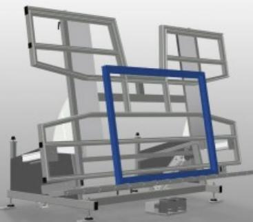
用于垂直和水平安装的组装工作台。钢制结构、坚固稳定。在从垂直输送切换至水平输送或相同时十分重要。时垂直和水平安装的理想之选。通过可无级调节的无级中间位置实现符合人体工程学原理的作业。由气动翻转。可在垂直方向上以气动方式调节高度。带塑料滑条的工作台支撑面。可气动升降的滚轮支架。两个侧面、气动夹具（可降下）。四路压缩空气接口。
