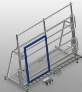
用于垂直安装的组装工作台。钢制结构、坚固稳定。 垂直安装的理想之选。可集成于生产线上。通过可无级调节的无级中间位置实现符合人体工程学原理的作业。通过气缸调节高度。装置有钢辊的滚轮支架。带塑料滑条的工作台支承面。两个可水平移动的型材夹具。四路压缩空气接口。
