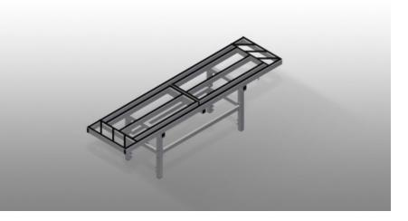
用于在特殊元件和幕墙上进行所有组装工作的组装台。钢制结构、坚固稳定。用于在特殊元件和幕墙上进行所有组装工作的组装工作台。可向两个方向拉出。该组装工作台是较大型元件组装的理想之选。由于底座采用的狭长的设计构造、因此能够从各个侧面十分轻松地触及元件。可移动组装工作台。支承面带橡胶型材。通过可大范围调节的支承面、即:将支撑面拉出并且移动工作台、能够根据加工的元件对工作台进行优化调整。用于组装生产线的机型:水平对齐的轨道确保了支承面的平整、从而能够让工作台顺利移动至支承面上;工作台可移动并且能够在轨道上十分轻松地定位;通过两个或若干工作台的组合、可对支承面进行任意的扩展;该工作台是较大型元件组装的理想之选;如果不需要该工作台、则可将其折起并推至一侧;在边缘区域、菱形排布的支架可用于纵向存放型材。
