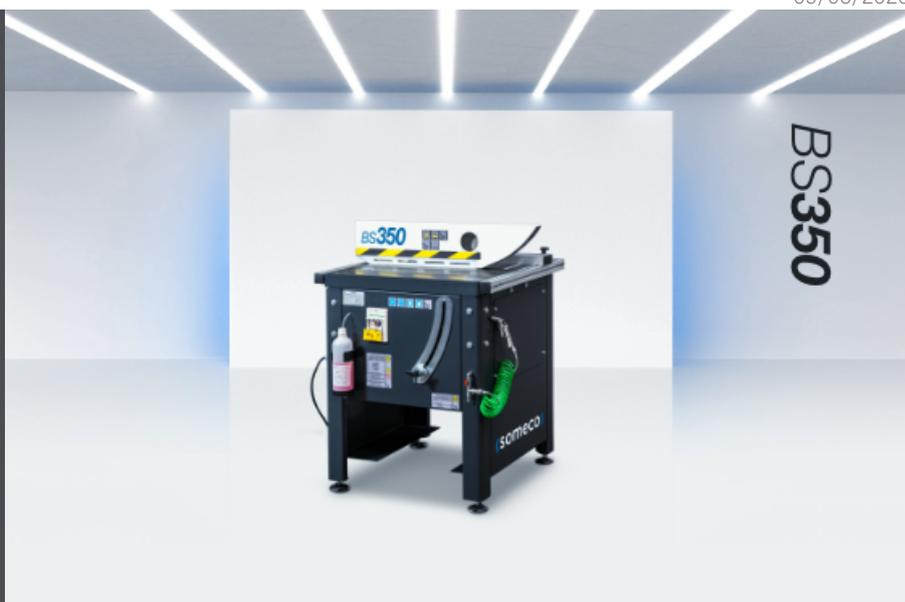
上行式的单头切边机，适用于挤压型材和铝合金平板。机器结构特别结实，因此其准确而精密切割，使型材断面完全平行。该机器上可以安装支撑辊道来扩大机器的通用性。锯刀保护装置能够确保工作上最安全的条件。
