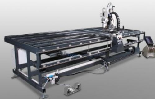
创新型、高效的五金件钻孔及上螺钉工作站、适用于角型铰链式框架。加工特别迅速、精准、该机器可极大提高生产窗子时的效率。通过简便的操作和符合人体工程学的加工流程、一名员工即可完成向角型铰链上钻孔、放置并拧紧螺钉的操作。由于可移动止挡系统的存在、省去了通过模板来钻支撑孔和螺钉孔这种高花费的做法。在加工含有多个窗扇的框架时、该单元可以转动90°。在给含有多个窗扇的框架钻轴座支撑孔时、可通过光栅间距在Y方向上定位调节装置。螺钉进给单元处于垂直方向、可在推移滑座上手动行进；通过它、角型铰链将被螺钉固定在闭合的框架上。该单元装有一个自动螺钉补给装置、一个用于拧紧钻尾螺钉的螺丝刀涡轮以及气动螺钉紧固深度控制装置。气动框架夹紧及定位装置可经由台中心点行进。可能的框架折边尺寸为360至3400 mm。两个气动可下降折边止挡带有转塔、适用于多至四种不同的框架结构深度。用于显示螺栓位置的激光装置。
