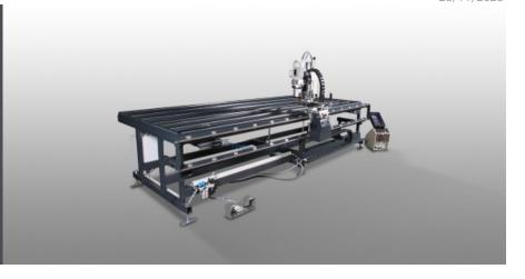
创新型、高效的五金件钻孔及上螺钉工作站、适用于角型铰链式框架。加工特别迅速、精准、该机器可极大提高生产窗子时的效率。通过简便的操作和符合人体工程学的加工流程、一名员工即可完成向角型铰链上钻孔、放置并拧紧螺钉的操作。由于可移动止挡系统的存在、省去了通过模板来钻支撑孔和螺钉孔这种高花费的做法。在加工含有多个窗扇的框架时、该单元可以转动
