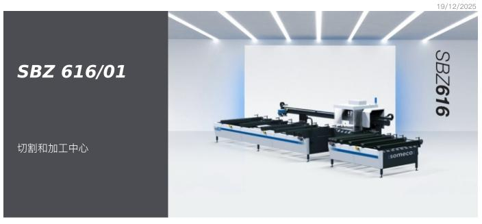
切割中心可用于自动切割。受控轴切割单元能够确保以最高的加工速度和最佳的质量水平进行切割。切割中心的切割角度可以进行编程、可以 按尺寸切割型材、用于生产门窗和幕墙。
