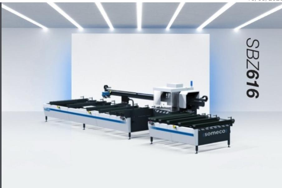
切割中心可用于自动切割。受控轴切割单元能够确保以最高的加工速度和最佳的质量水平进行切割。切割中心的切割角度可以进行编程、可以按尺寸切割型材、用于生产门窗和幕墙。
