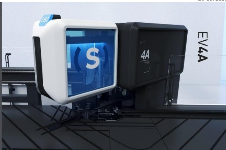
EV 4A 是 CN 清洁机、用于 PVC 框架的角度。4轴校对、全自动周期、用适当配置能够认定工件的尺寸。配有 275 mm 直径的清洁刀、通过不同加工程序可清洁型材的外角。另外、EV 4A 还配有带刀的上组和下组来清洁焊缝。上组和下组的刀片可以清洁内侧角。内、外角的加工还包括上/下钻孔/铣削、来清洁密封圈的槽。通过 CNC PC、可以单独控制每工位、而且可以控制设备的自动或手动运转以及工作周期。根据所安装的不同工具、设备可以加工标准、丙烯酸、覆盖等型材。EV 4A 有三个不同型号：手动、半自动（配有旋转台）和全自动（配有旋转台和拆卸台）。
