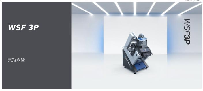
该自动槽孔铣床可以在PVC 工件上开槽孔或者钻铣通风孔。三个气动前进的工位、可单独使用;通过滑块导轨可以快速进行工件的定位;另外、有6 档测量和6 档角度标记。打孔工位由不同步、三相电动机和皮带间接传动控制的。四个可调节气动夹具可以有效夹持大尺寸型材。夹具采用的气动方式移动定位。
