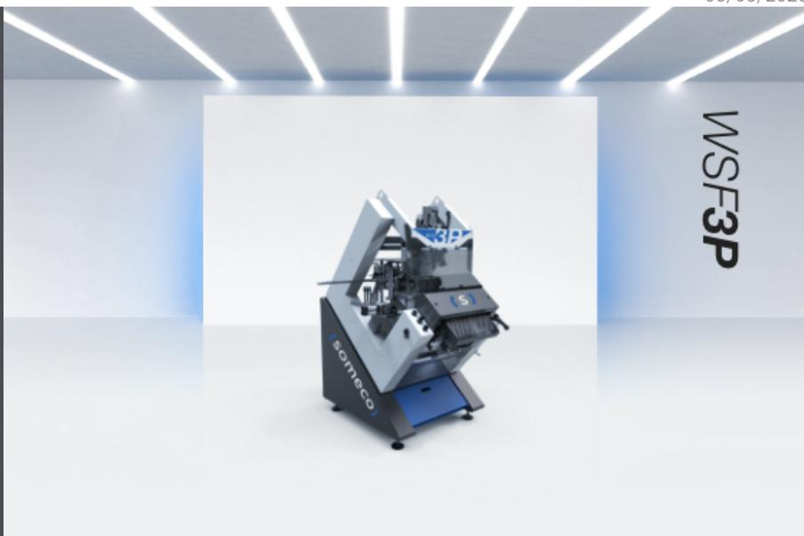
该自动槽孔铣床可以在PVC 工件上开槽孔或者钻铣通风孔。三个气动前进的工位、可单独使用；通过滑块导轨可以快速进行工件的定位；另外、有6 档测量和6 档角度标记。打孔工位由不同步、三相电动机和皮带间接传动控制的。四个可调节气动夹具可以有效夹持大尺寸型材。夹具采用的气动方式移动定位。
